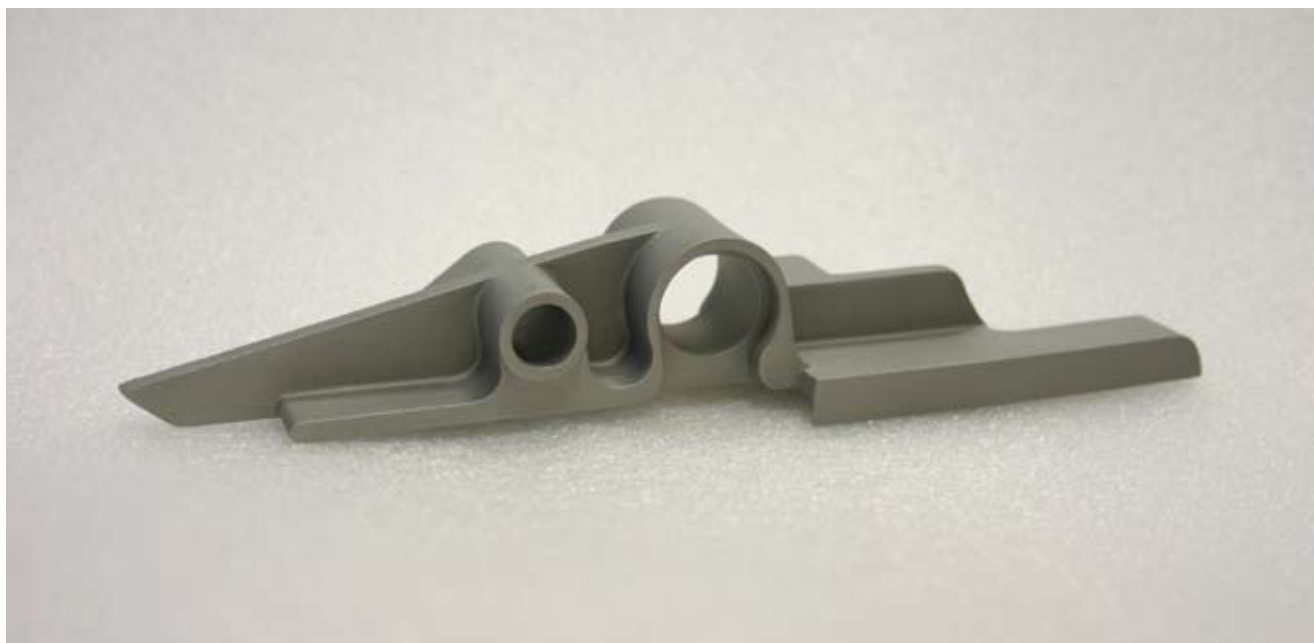
Bild 3: Bandführung aus 1.7131 für Verpackungsmaschinen; Größtmaß: etwa 200 mm, Gewicht: etwa 300 g
