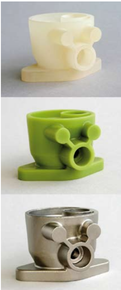
Bild 1: Rapid Prototyping im Feinguss; von oben nach unten: Stereolithographiemodell, Wachsmo- dell, Feingussteil aus Edelstahl
